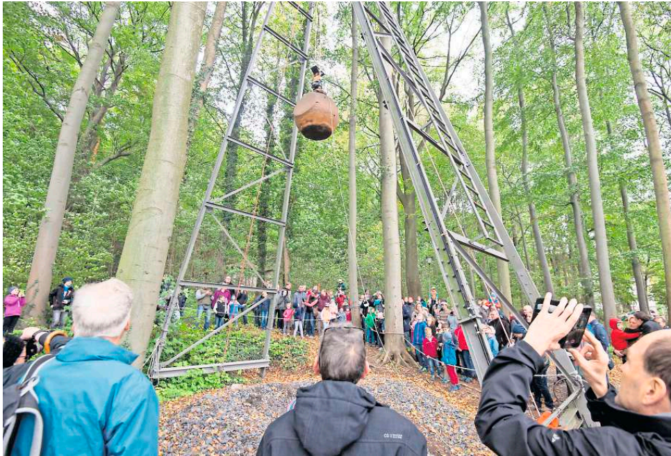
Künstliche Mini-Erdbeben erzeugt der Fall dieser vier Tonnen schweren Stahlkugel aus 15 Metern Höhe. FOTO: RICHTER
